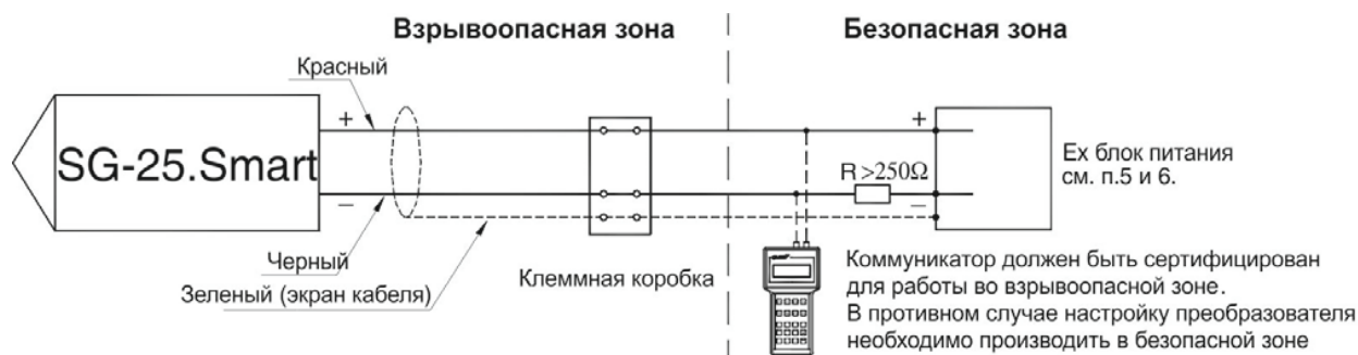
Рисунок 2 – Схема электрических подключений преобразователей модификаций PC-SG-25.Smart, PC-SG-25S.Smart в Ex исполнении
